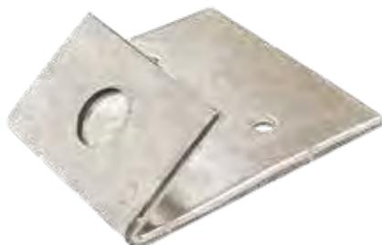
O sistema de montagem de painéis de esquadria TFPC é utilizado para montar os painéis de madeira entre si. Ajuda a minimizar as fugas de ar ao nível da junta entre os painéis de madeira e evita danificar o isolamento durante a utilização de parafusos isolados. Pode igualmente ser utilizado para fixar os painéis a uma travessa de madeira. O TFPC apresenta um guia para o parafuso, abrangido por uma patente, que garante uma fixação rápida e precisa..
