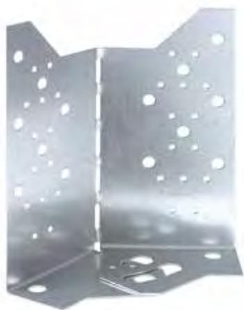
O esquadro ABF é recomendado para a realização de uma cintura sustentadora de terraços em madeira sobre betão. Tem um ângulo regulável na obra, o que permite obter um ângulo interior entre 90° a 150°. Os sinais visuais na peça permitem obter um ajuste ao ângulo pretendido.
