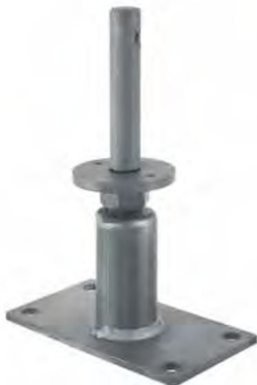
O pé de prumo PGS destina-se a sustentar cargas verticais e horizontais. Pode sustentar cargas elevadas de compressão. O seu carácter regulável permite realizar um ajustamento do prumo de madeira de 130 a 195 mm relativamente ao solo. Por último, a ligação ao prumo é efetuada através de um tubo de Ø24 mm, inserido dentro do prumo para um resultado discreto.
