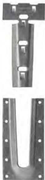
O estribo de cauda de andorinha em aço ETSN é uma conexão inovadora e muito discreta. Permite reproduzir a estética de uma montagem tradicional de cauda de andorinha. A parte fêmea é colocada sobre a viga de suporte com os parafusos CSA ou os pregos CNA, enquanto a parte macho é fixada na extremidade da viga suportada com os parafusos de cabeça plana.
