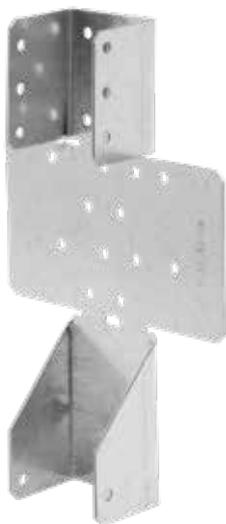
O SPR permite a fixação de varas em elementos de madeira e betão. A inclinação é regulada na obra para inclinações até 45° no sentido ascendente ou descendente. Este ajuste deve ser realizado uma única vez no sentido da inclinação desejado.
