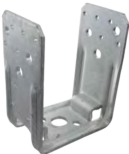
As PU permitem a fixação de prumos sobre um suporte já existente (balcão, terraço) e asseguram a proteção do prumo contra a humidade (pousado a 20 mm do solo). A sua instalação é simplificada graças a um furo oblongo na parte de baixo.
