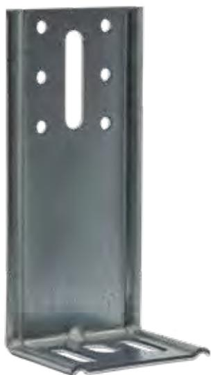
Os esquadros de revestimento de proteção EBC são utilizados para a realização de isolamento em fachadas exteriores. Permitem a fixação de travessas que constituem a esquadria secundária. Esta esquadria é desalinhada da parede e serve de suporte ao revestimento exterior de tipo de revestimento de proteção. Estão em conformidade com os cadernos 3194, 3316 e 3422 do CSTB, bem como com a ETAG034.
