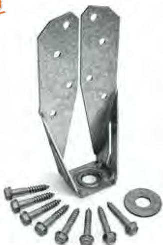
As ancoragens DTT2Z foram concebidas para ancoragens leves de elementos de construção. O DTT2Z fixa-se facilmente à madeira a partir de 38 mm de espessura com os parafusos de conexão SDS Simpson Strong-Tie Strong-Drive incluídos. Adapta-se a uma haste roscada de 12 mm ou a uma conexão de betão de Ø12 mm.
