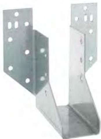
O estribo SHT é um suporte de suspensão utilizado para a conexão de asnas pequenas num elemento de madeira, sendo regulável em altura na obra, uma vez que pode ser instalado nas abas planas ou nas abas dobradas do suporte.
