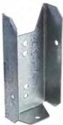
O FB24 permite a fixação de travessas horizontais. O revestimento permite a utilização no exterior. Tanto pode ser utilizado na horizontal como na vertical e adapta-se à madeira com uma largura de 40 mm.
