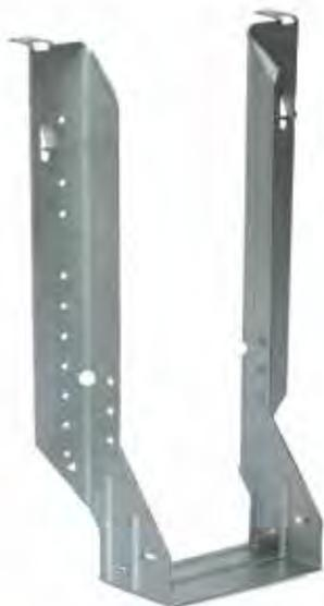
Os estribos IUSE são fáceis de instalar graças às flanges superiores, ao mesmo tempo que garante a fixação do elemento inferior através de "strong grip". A pregagem é feita nas flanges laterais após um pré-posicionamento com o "speed prong".
