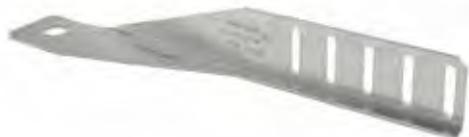
As placas para paredes de cortina CCW, modelos para lado direito ou esquerdo, são esquadros cujo objetivo é fixar os pilares de madeira das paredes de cortina a uma laje de betão. Estas placas permitem obter uma distância de 50 mm entre os dois elementos. As placas foram concebidas para suportar cargas perpendiculares às fibras da madeira (compressão/tensão) e permitir a liberdade de movimento do pilar, no sentido das fibras, até +/- 10 mm.
