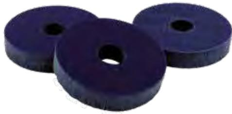
A anilha SITW associa-se à fita SIT para constituir um sistema de desempenho em estruturas em CLT que tenham de cumprir um nível elevado de desempenho acústico. É intercalada entre uma anilha de metal e o CLT aquando da montagem com parafuso de modo a evitar a transmissão de vibrações pelas fixações.
