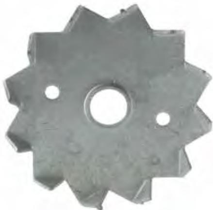
O KOLLIBRODD é uma placa em chapa cujo perímetro é cortado em forma de dentes e é utilizado como acessório para a estivagem de embalagens de madeira. Os seus dentes estão dobrados para cima e para baixo da placa. O perfil KOLLIBRODD permite a total penetração dos dentes na madeira que compõe as paletes ou as caixas e as pranchas dos materiais rolantes.
