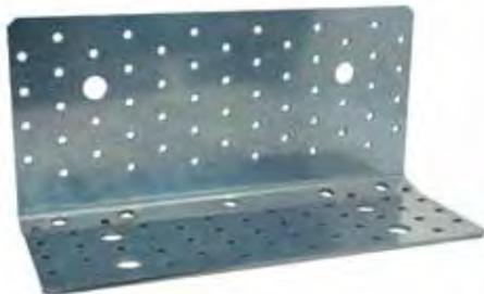
O esquadro reforçado AB255HD foi especialmente desenvolvido para a fixação do painel CLT em suporte de madeira ou em suporte de betão. Extremamente polivalente, é particularmente resistente ao cisalhamento graças a uma geometria otimizada.
