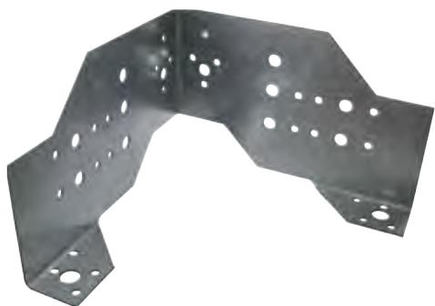
A conexão FCC assegura a ligação de paredes de esquadria sobre lajes de betão. Os furos para pregos e parafusos permitem adaptar a fixação em função das configurações. Esta conexão pode, eventualmente, ser associada a uma fita de cintagem perfurada tipo FP30 a fixar sobre os pilares verticais.
