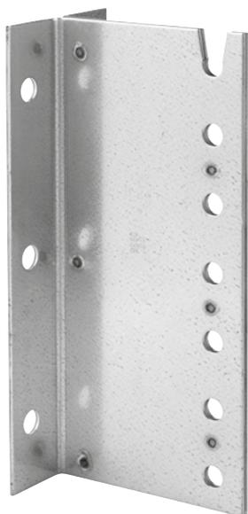
O estribo de alma interior BTC é uma conexão discreta, que permite uma fixação em elemento rígido. O número de cavilhões e de ancoragens pode ser escolhido livremente em função da carga aplicada. O estribo BTC permite suportar esforços nas três direções. Por conseguinte, as montagens de madres inclinadas podem também ser efetuadas com simplicidade e em total segurança.
