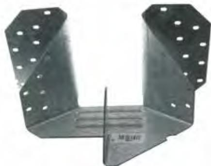
Estes estribos são usados na asna pequena com uma secção de 38 mm. Possibilitam a realização de uma garupa através da montagem das semi-asnas da telha e da viga da perna da asna (2 telhas ou 1 telha + 1 viga de perna de asna). Os valores característicos são indicados para diferentes configurações.
