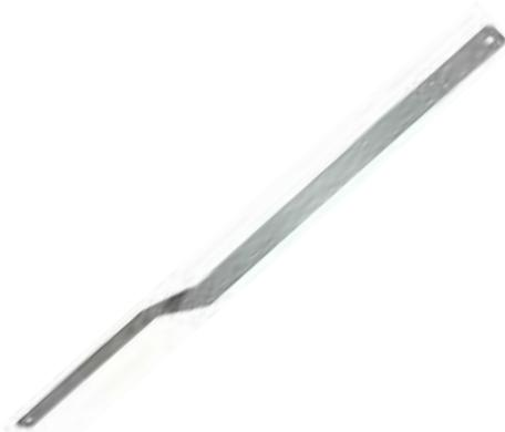
As fitas de cintagem torcidas MTS garantem uma resistência à tração entre 2 elementos. Mais adaptadas às carpintarias e aos contraventamentos, estas fitas de cintagem oferecem inúmeras funcionalidades. O cotovelo permite a dobragem a 90° no sentido longitudinal, permitindo, assim, a montagem de elementos cruzados a 90°.
