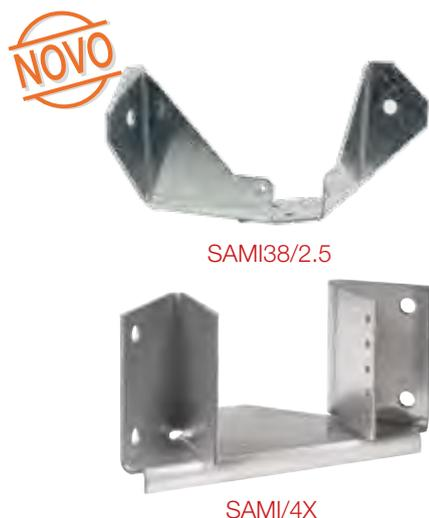
Este suporte permite suportar as asnas nos cantos em alvenaria a 90°. Está disponível em 38 mm de largura ou dobrável em largura entre 76 e 120 mm.
