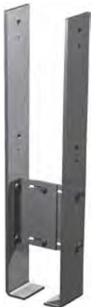
Os pés de prumo CMS são constituídos por duas peças de aço galvanizado para uma utilização no exterior. Trata-se de um pé de prumo regulável em largura para prumos entre 80 e 140 mm (CMS) e entre 115 a 165 mm (CMR).
