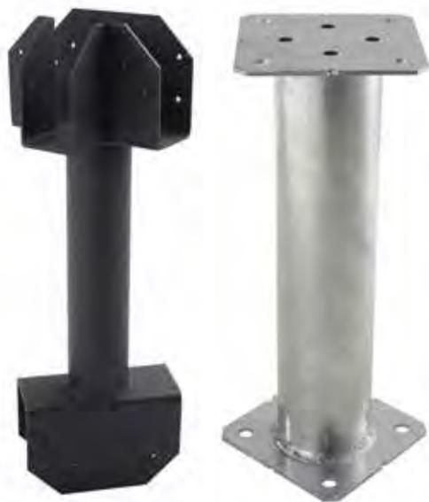
O prumo metálico configurável OSP pode ser utilizado para suportar cargas axiais, descendentes e ascendentes, até à classe de serviço 3. O OSP é constituído por um tubo circular e uma placa à escolha, soldada a cada extremidade.
