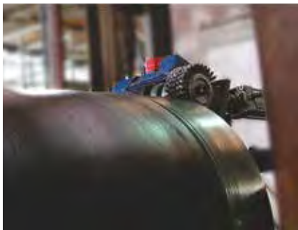
Spazzola a mazzetti ritorti che lavora su una testa di tubo / Twisted knot brush processing a tube end
