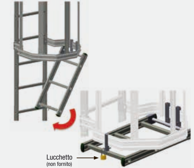
CANCELLETTO ANTI INTRUSIONE (alluminio e inox + porta lucchetto)
